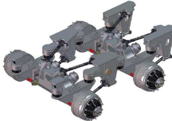
Рисунок 4.6 - Осевой агрегат с подвеской с резиновыми упругими элементами
