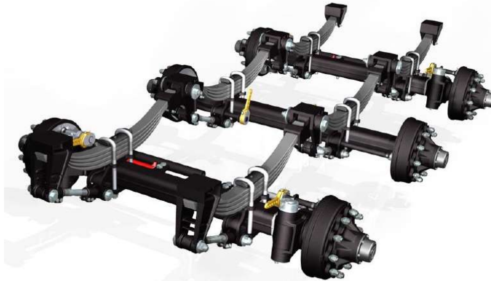
Рисунок 4.2 - Осевой агрегат с рессорной подвеской
